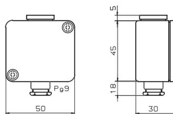
**Gehäuse** Makrolon mit Kunststoff-Kabeleinführung Pg 9 / M 16 x 1,5
